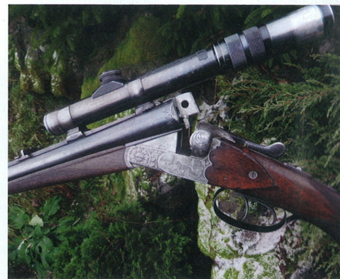
Det korrekte navn for låsekonstruktionen på dette våben var "Simson-Jäger-Schildzapfen-Verschluss". Forskellen på denne konstruktion og den almindelige måde med låseknaster i forlængelse af hinanden er, at her ligger de to låseknaster ved siden af hinanden.
